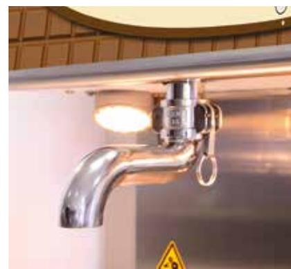
Fornito di **tubo proboscide** in acciaio, di semplice e facile regolazione, per alimentare l'arco diffusore ed ottenere così una completa ricopertura.
